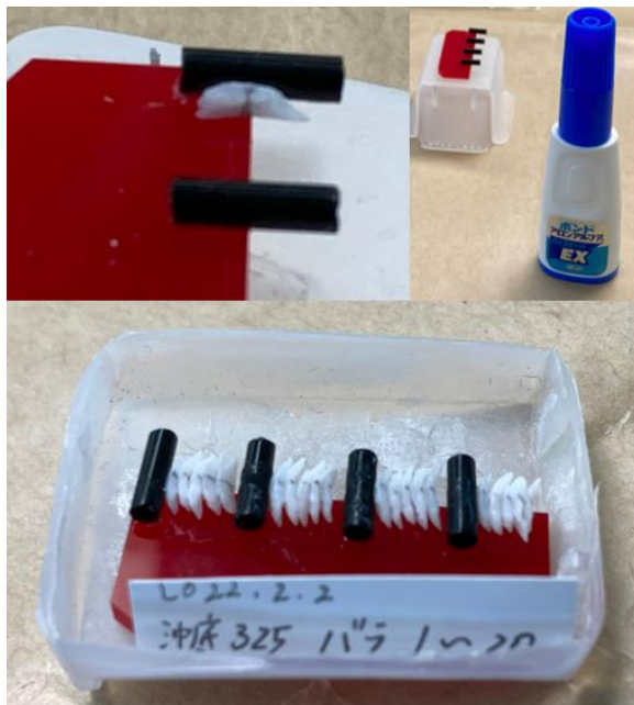
図1 ホッケの扁平石をアクリル小片上に核の位置を揃えて並べ接着剤で固定する。黒いビーズを5個体ごとに挟む。
