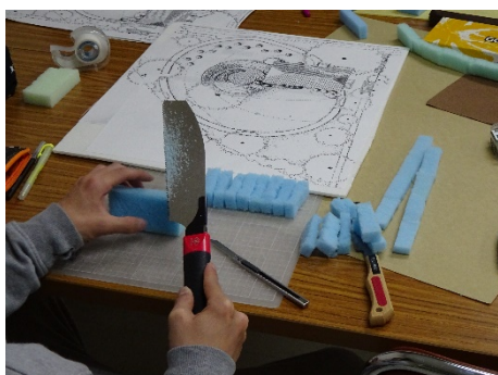
図 46 : 模型製作のプロセス 生垣の製作
