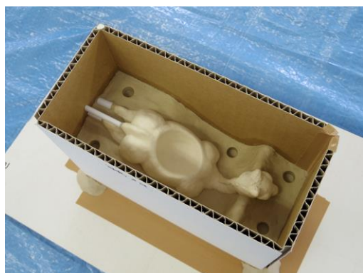
図 7. 型枠にセット
